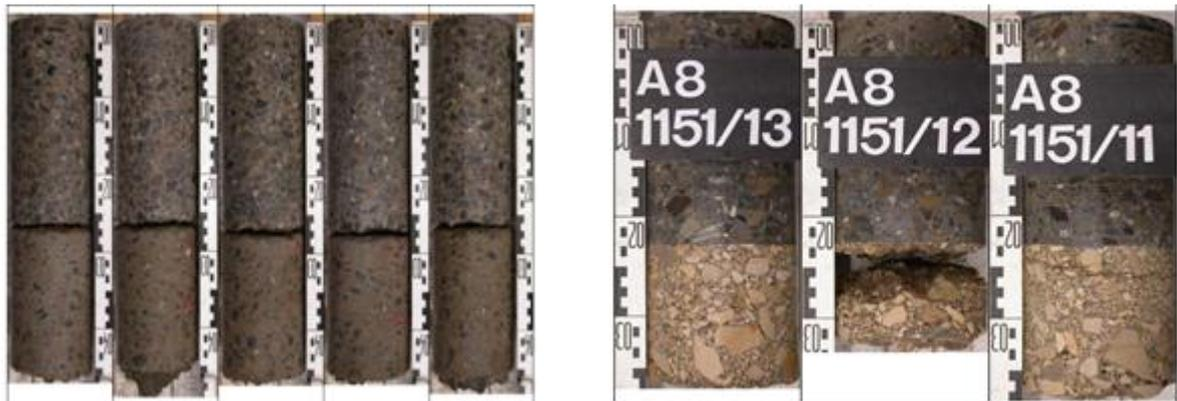
**Abbildung 7: Bauweise Betondecke auf Tragschicht mit hydraulischem Bindemittel
