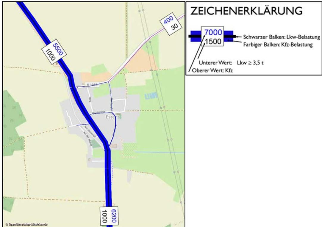
Abbildung 3: Verkehrsbelastungen Prognose-Bezugs-Fall 2030 [DTV - Kfz/24h und SV/24h]
