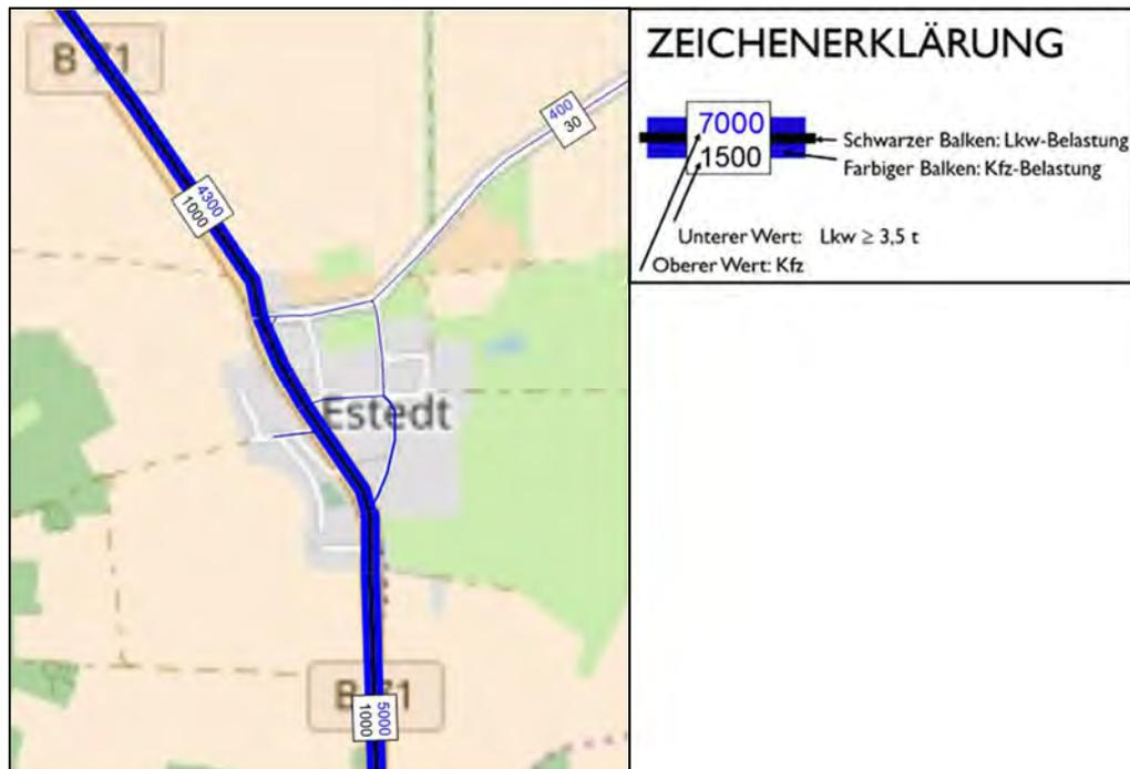
Abbildung 3: Verkehrsbelastungen Prognose-Bezugs-Fall 2030 - [DTV - Kfz/24h und SV/24h]
